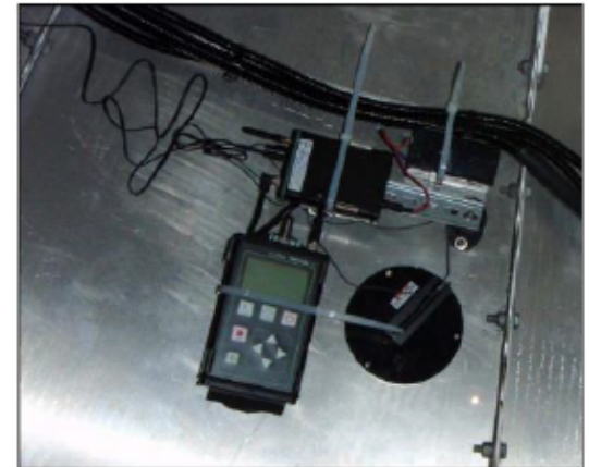
Abbildung 1: batsorder 2.0 inkl. WKA-Erweiterung 1.0 in der Bodenwanne einer Enercon E62
